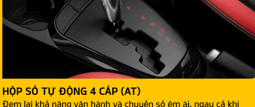
HỘP SỐ TỰ ĐỘNG 4 CẤP (AT) Đem lại khả năng vận hành và chuyển số êm ái, ngay cả khi lái xe trong tình trạng phải chạy-dừng liên tục khi kẹt xe
